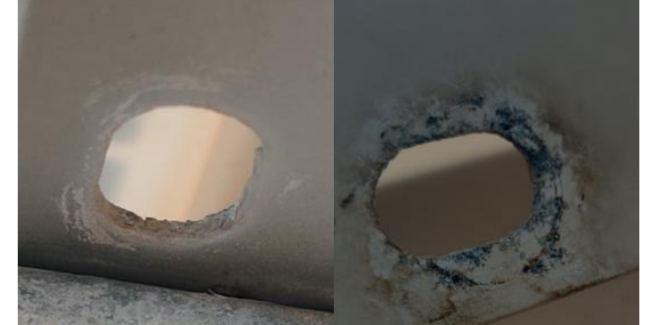
Açık denizdeki bir güneş santralinden paslanmış alüminyum çerçeveli güneş modülünün resmi
